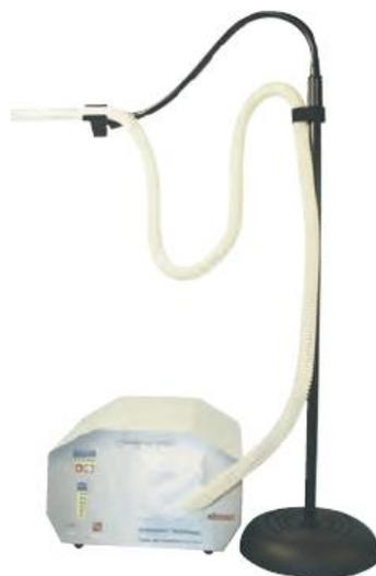
Система дымоудаления Surg-e-Vac™ разработана на основе высокопроизводительного центробежного насоса высокого давления. Установлен очень тихий двигатель, который используется для отвода хирургических дымов из зоны операции через вакуумный трубопровод в фильтр Quad Filter™, где эти дымы проходят очистку через ряд специальных фильтров.
